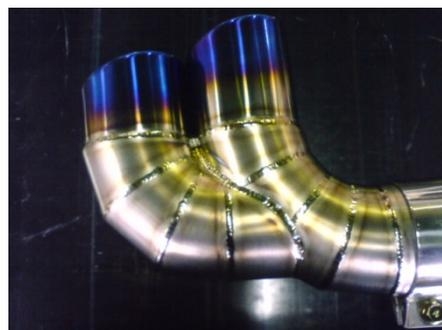
図1 全チタン製自動車排気系部材
